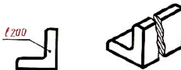
Рисунок 8. Нанесение размера длины детали
